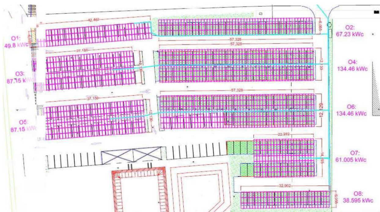
Figure 4 : Position des panneaux photovoltaïques au niveau du parking personnel
